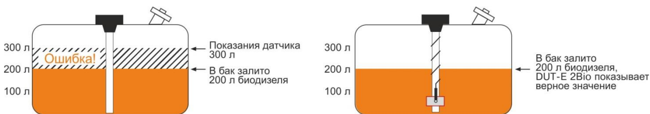
а) с применением обычного емкостного ДУТ б) с применением DUT-E 2Bio
